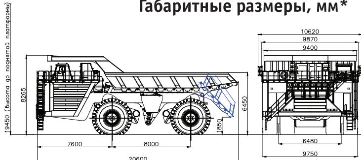
\*Габаритные размеры указаны для базовой комплектации самосвалов
