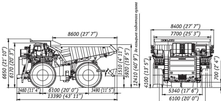
\*Габаритные размеры указаны для базовой комплектации самосвалов
